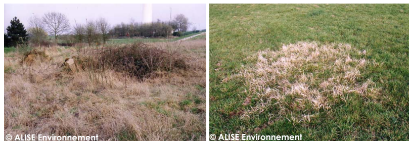
Photographie n° 7 : Indice de surface de cavités souterraines par changement de végétation
